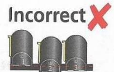
Les boîtes aux lettres **doivent** être alignées et réparties également le long du support.
